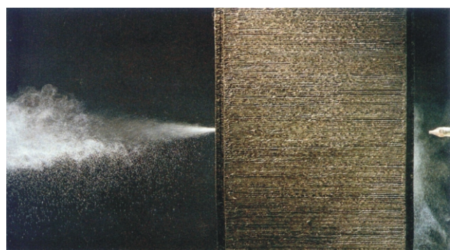
Reinigung der Speichermasse
