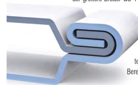
Abströmkanten ausgestattet, welche somit über eine 5-fache Materialstärke in diesem Bereich verfügen.
